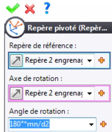
Dans le fichier d'assemblage, nous faisons coïncider 'le repère 2 engrenage avec rotation' avec 'le repère milieu' défini dans *la fonction fournie*. Cet étape a tourné l'engrenage d'un demi-angle du pas et nous montre Les deux engrenages s'engrenèrent.
